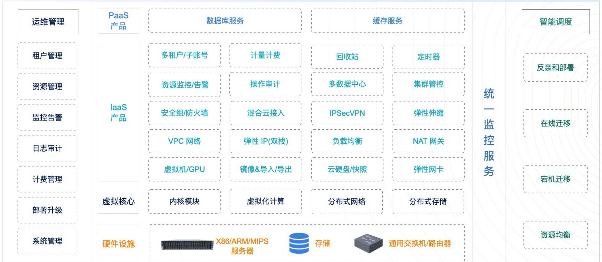
UCloudStack 平台整体产品架构由基础硬件设施、虚拟核心引擎、智能调度系统、核心产品资源、统一云管平台及运维管理平台组成,为平台租户、管理员及运营人员提供云平台管理和服
