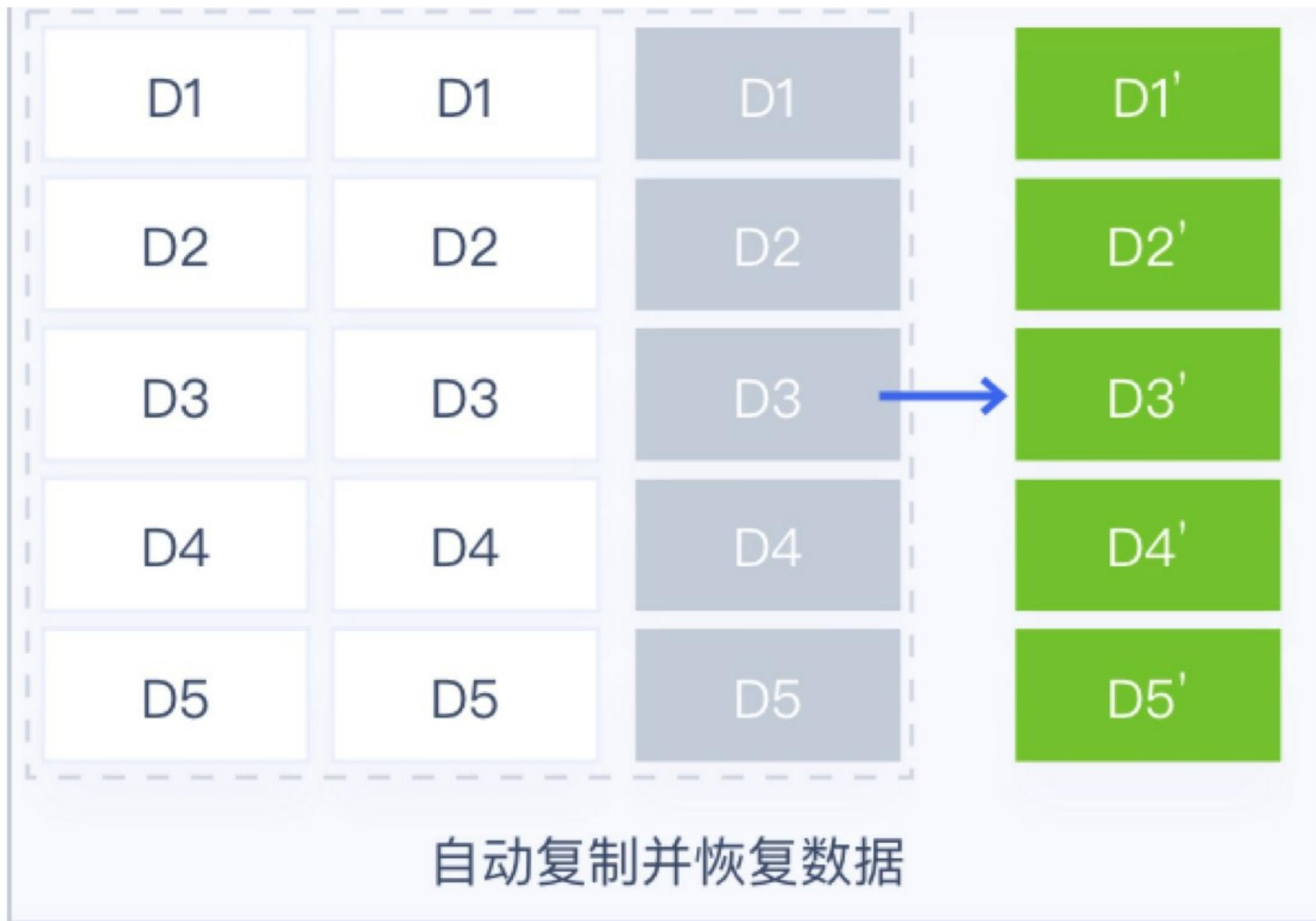
在存储节点无网络中断或磁盘故障等异常情况时,对象副本数据始终保持为 3 副本。仅当节点发生异常时,副本数量少于 3 时,存储系统会自动进行数据副本重建,以保证数据副本永久为三份,为虚拟化存储数据安全保驾护航。如上图第三个节点发生故障,导致数据 D1-D5 丢失并故障,存储系统会将对象数据的 PG 自动映射一个新的 OSD,并通过其它两个副本自动同步并重建出 D1'-D5',以保证数据始终为三副本,保证数据安全。
