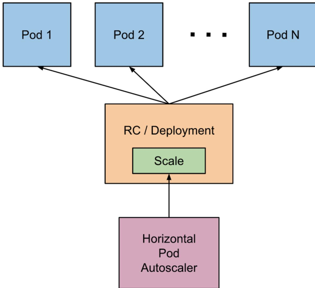
HPA在K8S中被设计为一个Controller,可以简单的使用`kubectl autoscale`命令来创建。HPA Controller默认30秒轮询一次,查询指定的Resource中(Deployment,RC)的资源使用率,
