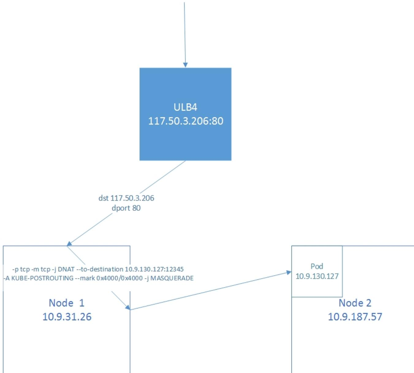
图中ULB4先将流量转发到Node1中,Node1中根据iptables DNAT规则,将流量转发给Node2中的Pod。需要注意的是,Node1将IP包转发到Node2前,对这个包有一次SNAT操作。准确
