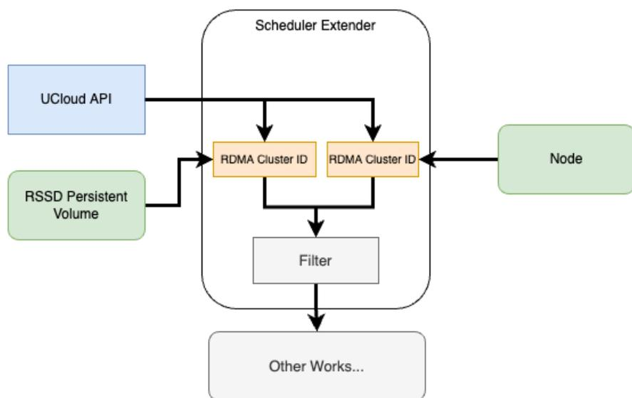
`scheulder-extender`会检查Pod是否使用了RSSD的PV, 如果使用了, 会调用UCloud API获取PV以及节点的RDMA信息, 并根据这个信息过滤掉不匹配的节点。
